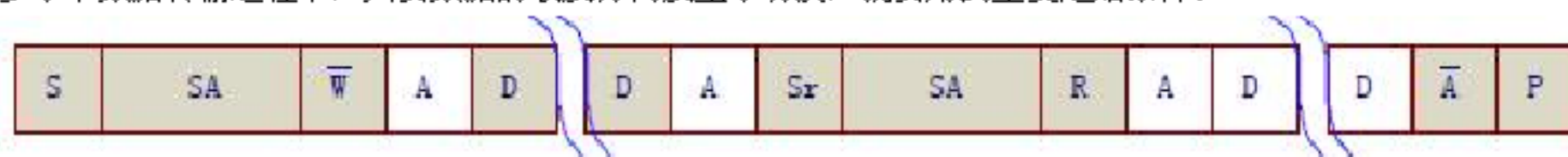
图 1.10 带有重复起始条件的多字节数据传输格式示意图
